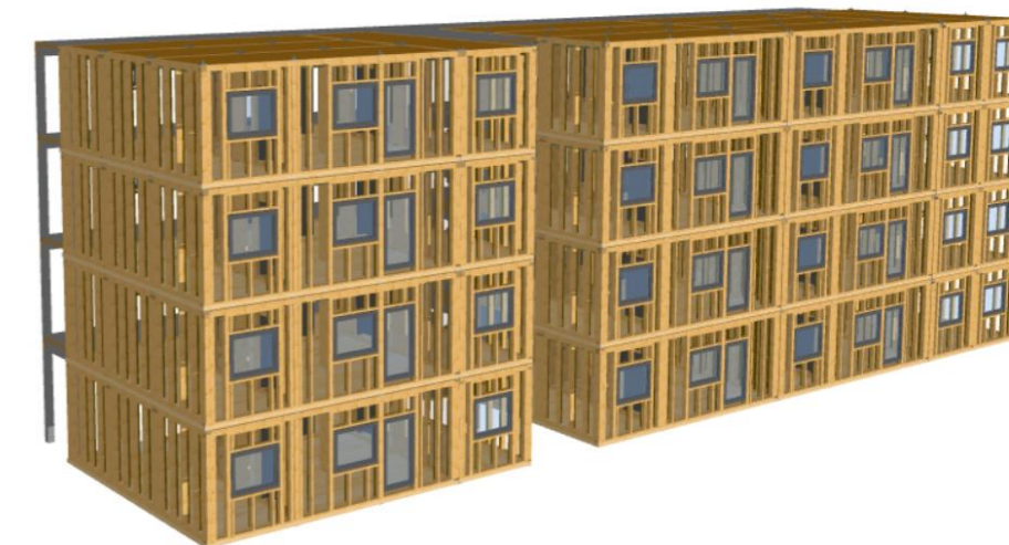
Obrázek 5: Reference 3D modulace dřevěných modulů
